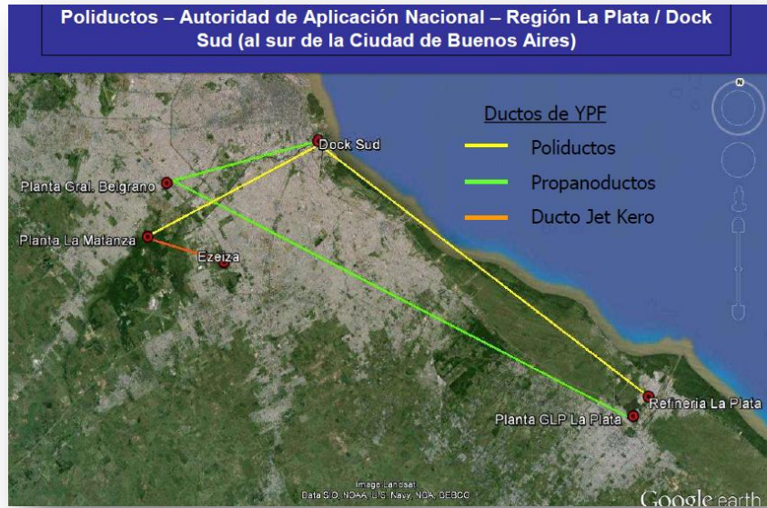
Gráfica 2. Sistema de poliductos de Argentina – Región La Plata 2
