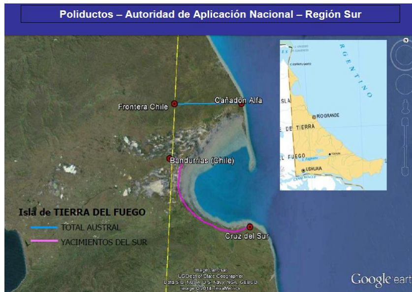
Gráfica 3. Sistema de poliductos de Argentina – Región Sur 3
