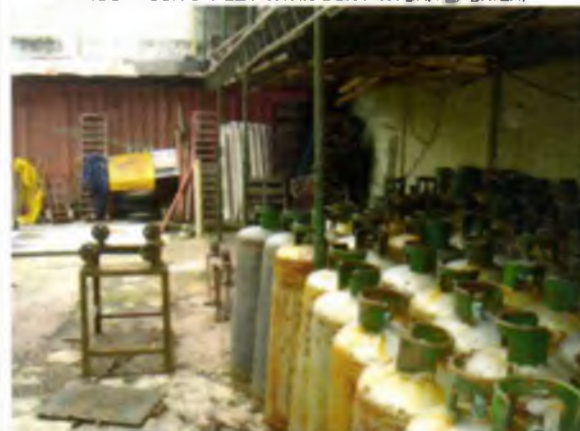
A LOS CILINDROS DE TRANSPORTE SE LES REALIZA MANTENIMIENTO PERIÓDICO. SE PULEN, SE LES APLICA ANTICORROSIVO Y SE PINTAN CON PINTURA EPÓXICA.
