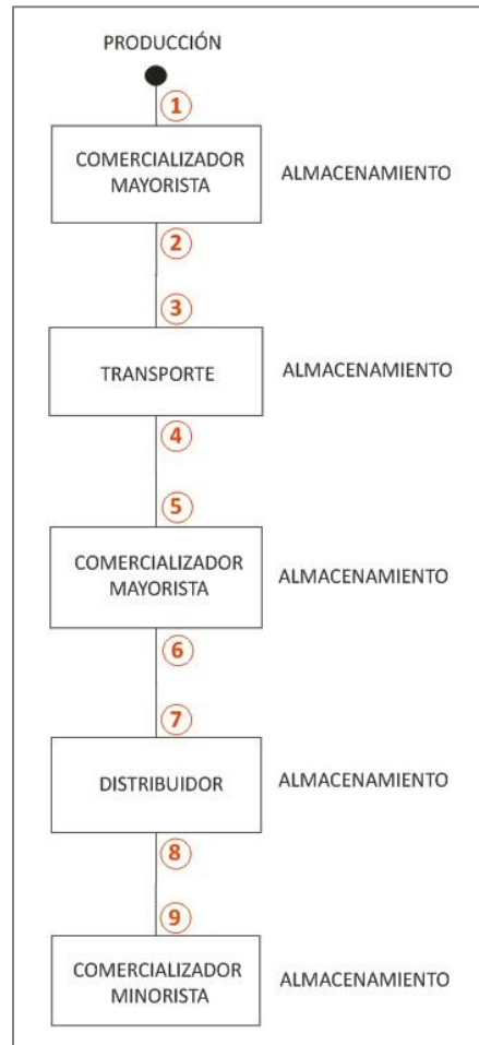
Figura 48. Puntos de medición de la calidad de GLP en la cadena de distribución.
