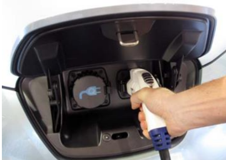
Figura 27: Estandar SAE J1772: Conector del EVSE se ajusta con el receptáculo del estándar SAE J772. Tomado de [1]
