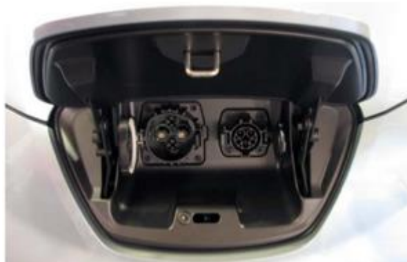
Figura 28: El receptáculo del estándar J1772 (a la derecha) puede recibir carga de EVSE nivel 1 o nivel 2. El receptáculo CHAdeMO de carga rápida (a la izquierda) usar un tipo diferente de conector. Tomado de [1]
