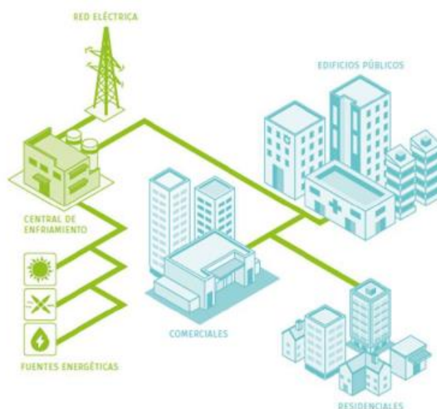
Ilustración 1. Esquema de un distrito térmico
